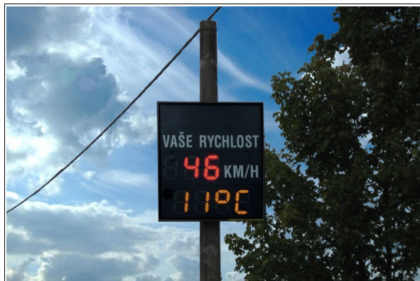
Vysoké u Žďáru nad Sázavou - radar, měření teploty, vyhodnocování a signalizace vzniku náledí
